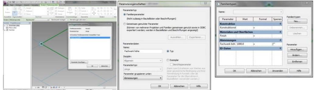
4. Danach verbinden wir die Punkte mit Referenzlinien, wie im Bild sichtbar. Durch die Wiederholung dieser Struktur entsteht unser 3D-Fachwerk.
