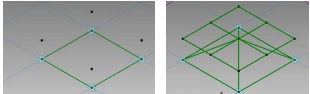
5. Dann platzieren wir Punkte auf den Referenzlinien, und in den Arbeitsebenen der Punkte, die quer zur Referenzlinie positioniert sind, erstellen wir ein Kreisprofil.
